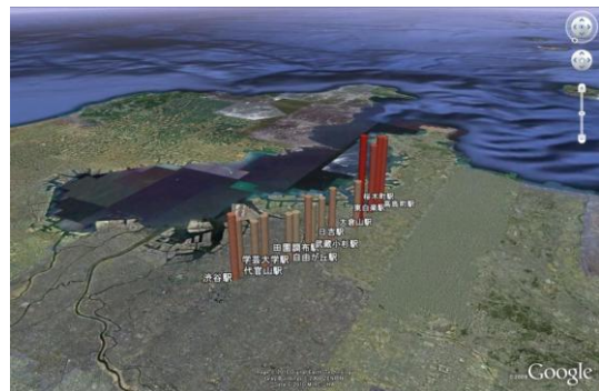
図6 GIS表示例#2: 鉄道路線に沿った最大加速度 東横線(渋谷/横浜間)の主要駅地点における最大加速度PGA
